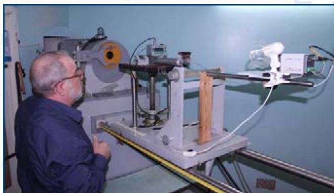
Поверка СИ ионизирующих излучений. Установка дозиметрическая УЦДГ-1.
