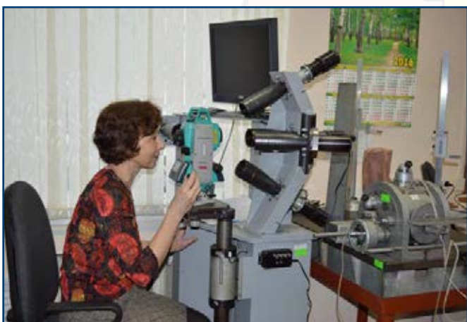
Поверка тахеометра на установке т. УКС Вега.
