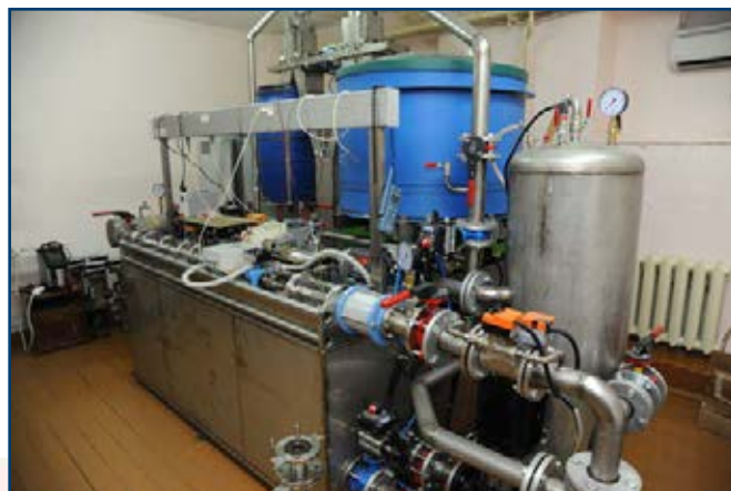
Поверочная расходомерная установка Поток ПУ-50.
