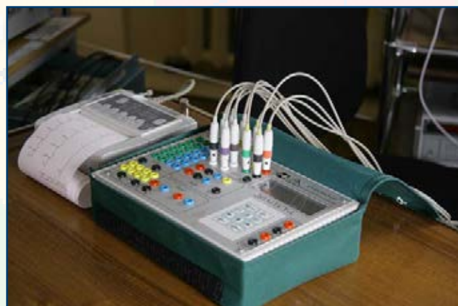
Генератор Диатест-4 для поверки электрокардиографических, электроэнцефалографических, электромиографических, реографических приборов.
