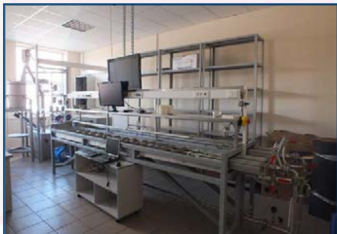
Установка для поверки счетчиков и расходомеров.
