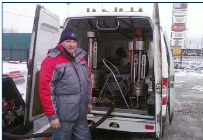
Поверка топливораздаточных колонок с использованием передвижной поверочной лаборатории ППЛ-ТРК.
