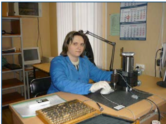
Поверка концевых мер на установке УКМ-100.
