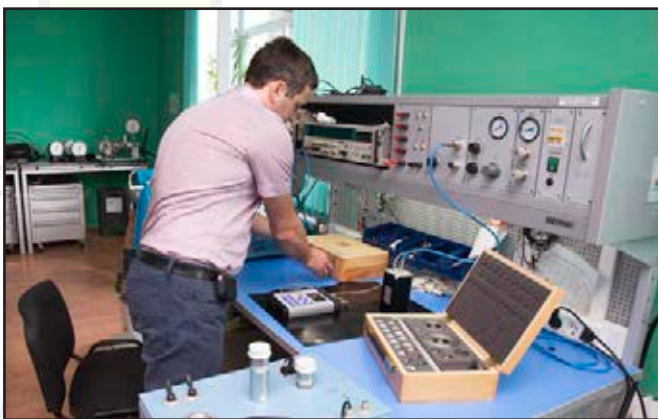
Стенд для поверки СИ давления Воздух500.
