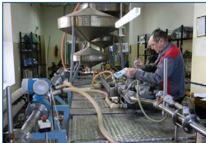
Поверка теплосчетчиков с использованием установки автоматизированной АКВА-100.
