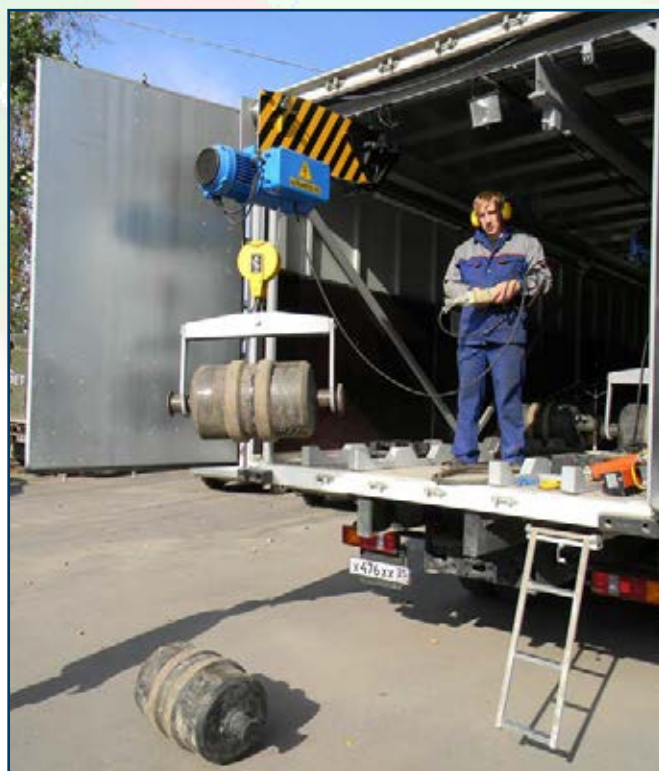
Поверка автомобильных весов с помощью передвижной весоповерочной лаборатории.
