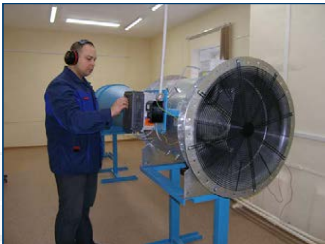
Подготовка к поверке анемометра на аэродинамическом стенде АДС-300/30М.
