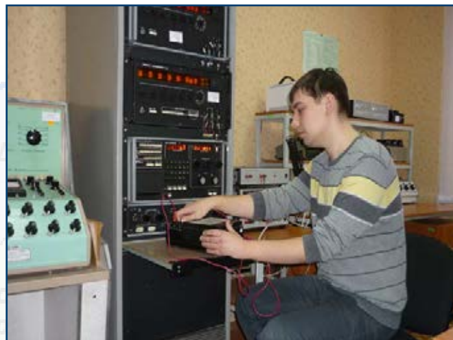
Поверка вольтметра на установке УЗ58.
