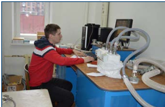
Поверка счетчиков газа т. СГК-4 на установке УПГСБ-6М.
