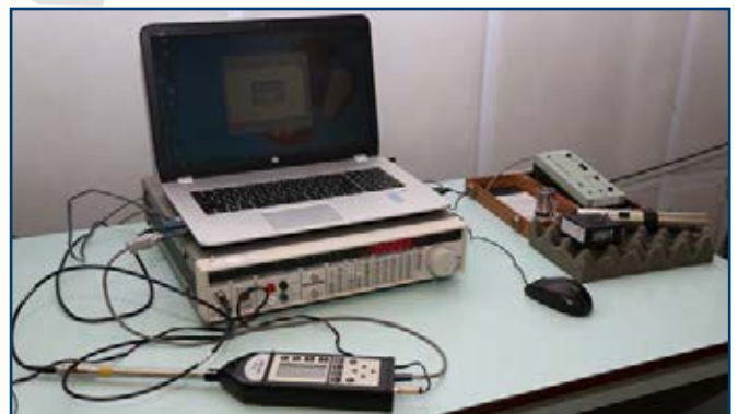
Автоматизированное рабочее место для поверки шумомеров-анализаторов спектра на базе генератора DS360.
