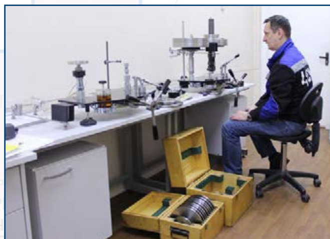
Измерительная поршневая система грузопоршневого манометра СРВ5000.
