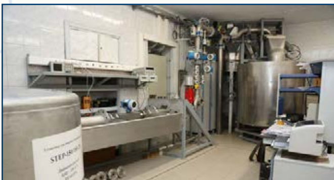
Установка для поверки счетчиков воды STEP-150/180-20.
