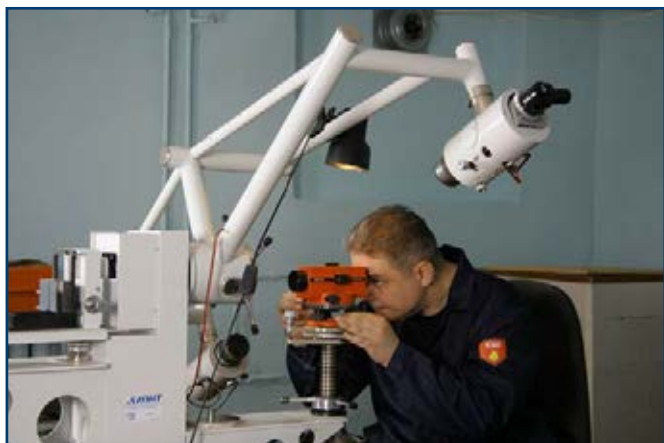
Поверка нивелира на установке автоколлимационной для поверки нивелиров и теодолитов АУПНТ.
