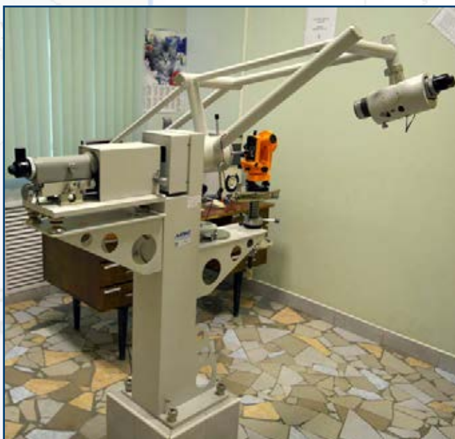
Установка автоколлимационная для поверки нивелиров и теодолитов АУПНТ.
